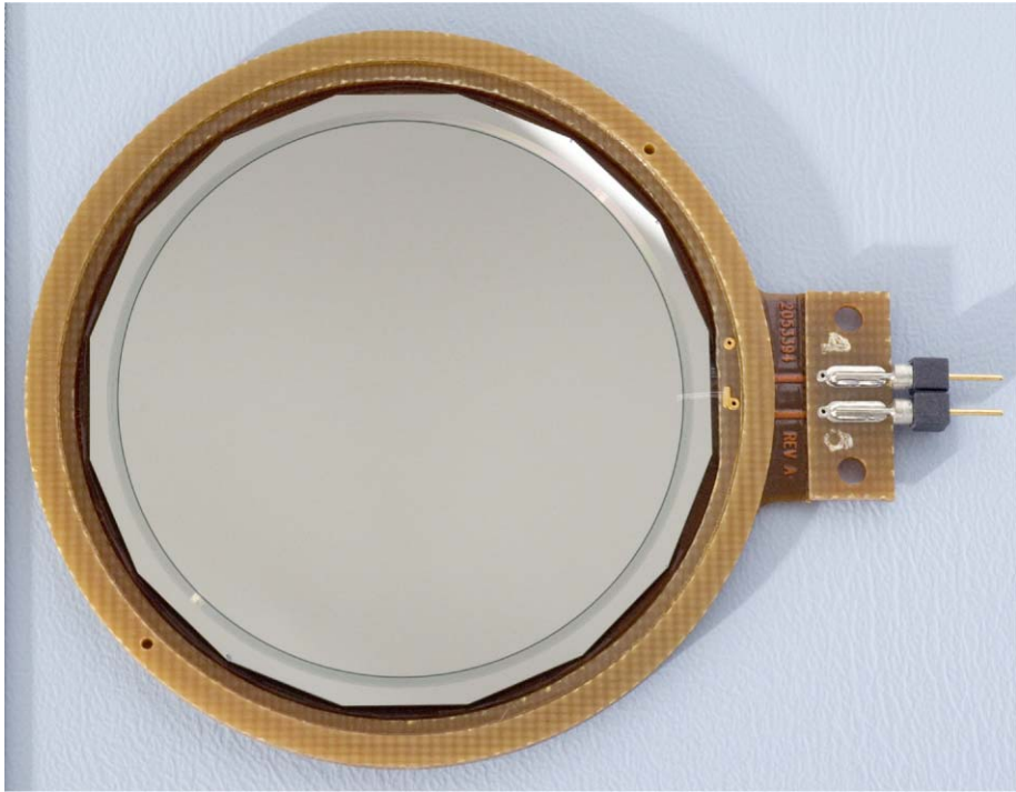
Fig. 9 Shows a HET stack detector (junction side)
